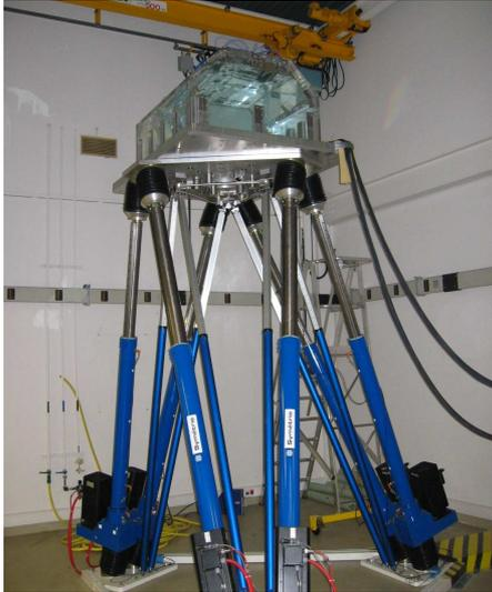
Fig. 10 : hexapod test rig
