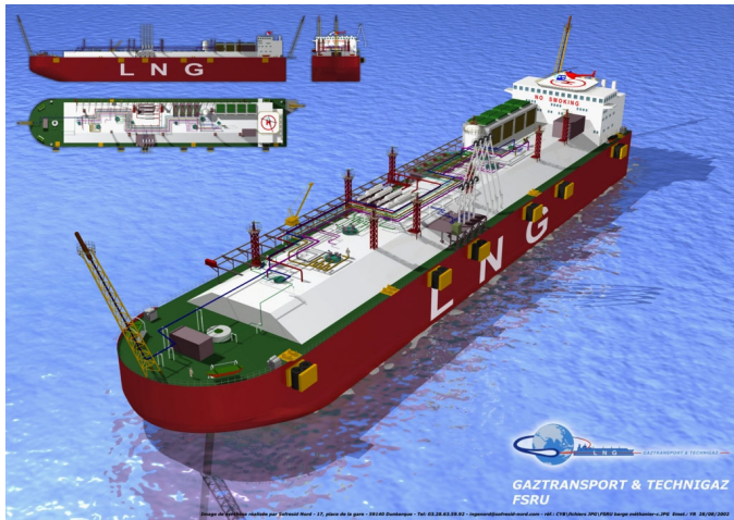
Figure 5 : Membrane 280,000 m 3 LNG FSRU
