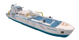
Design de navire de soutage et de ravitaillement en GNL « sans eau de ballast »
