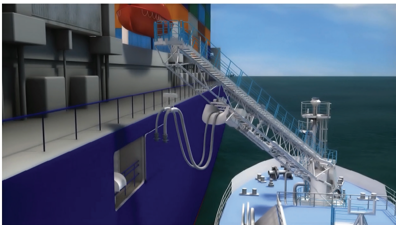
Figure 2. Reach4 – GTT LNG bunker mast.
